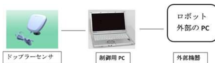
図1 ドップラーセンサによる人の動作解析システム
