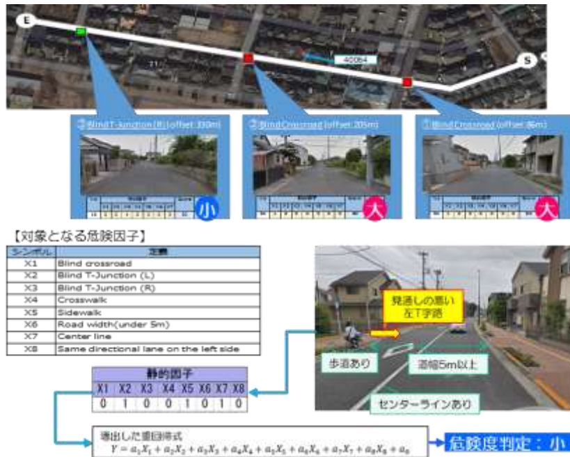
図⑮-4-4： 静的な危険因子を用いた危険度推定例
