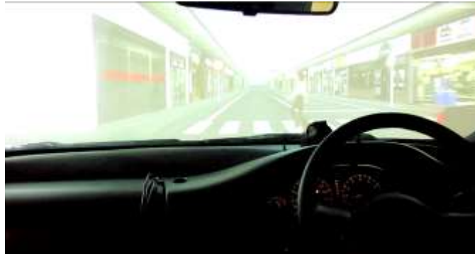
図6. ドライビングシミュレータを用いた歩行者飛び出し場面の再現
