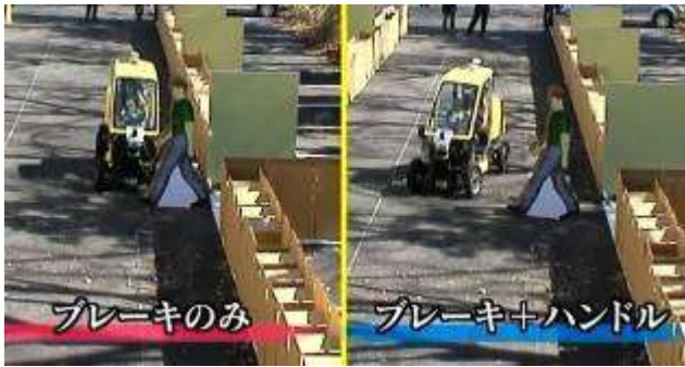
図4. 歩行者衝突回避実験(制動回避と操舵回避)
