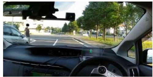
図⑨-13. HUD 実験風景Ⅰ 駐車車両回避徐行指示～歩行者飛び出し警告
