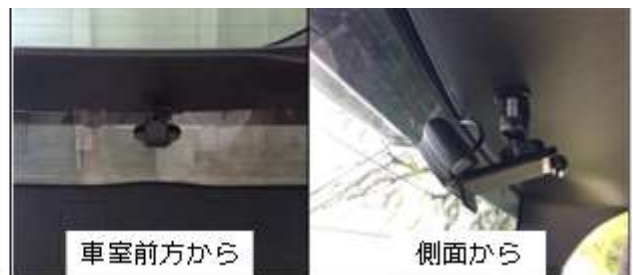
図⑬-4-15-2-8 USB カメラ取付けの様子
