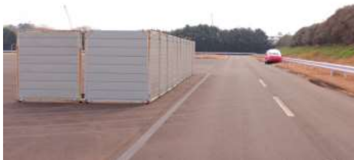
図⑬-12. 物陰に対する予見的減速制御介入の評価を実施した試験コースの様子
