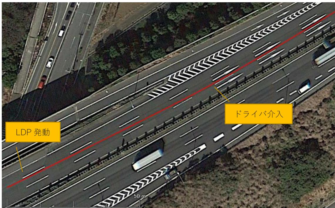
Fig. 7-31 日E車のLDPがセンターに収束しないケースの高精度IMUによる軌跡
