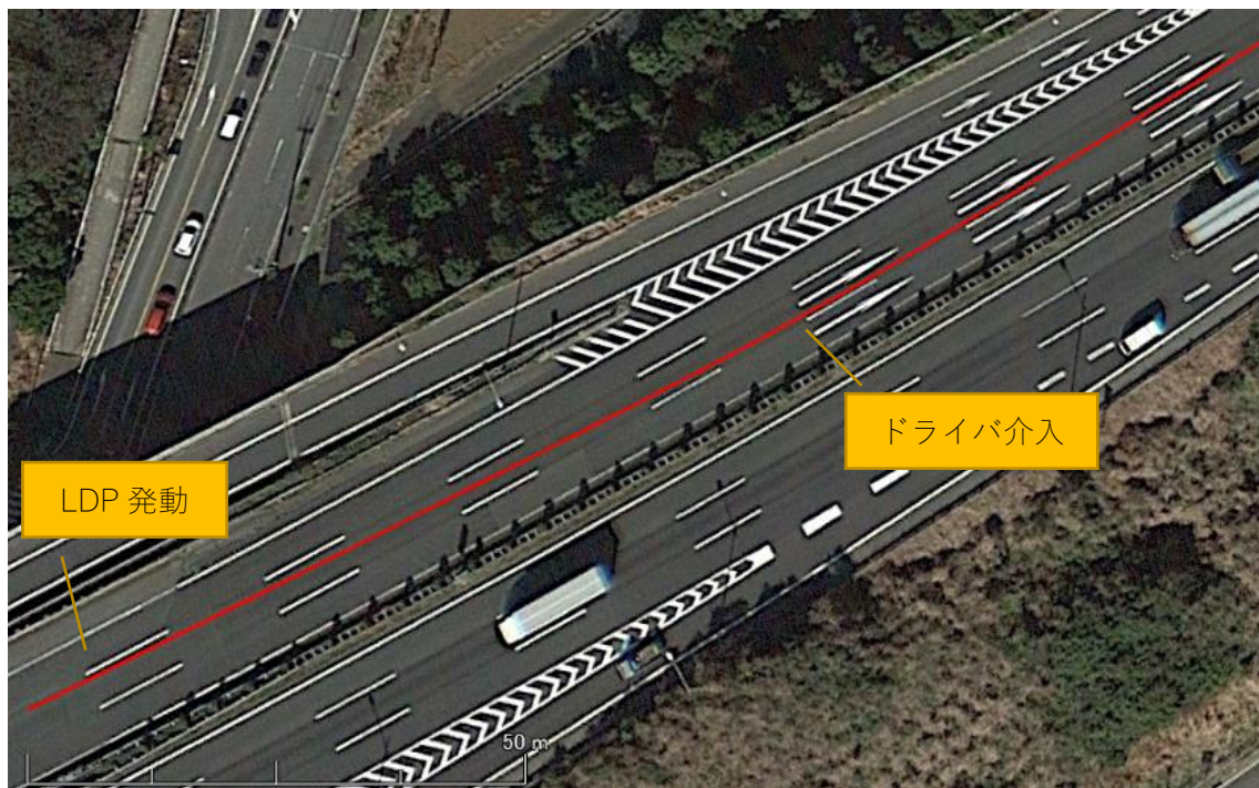
Fig. 7-31 日E車のLDPがセンターに収束しないケースの高精度IMUによる軌跡
