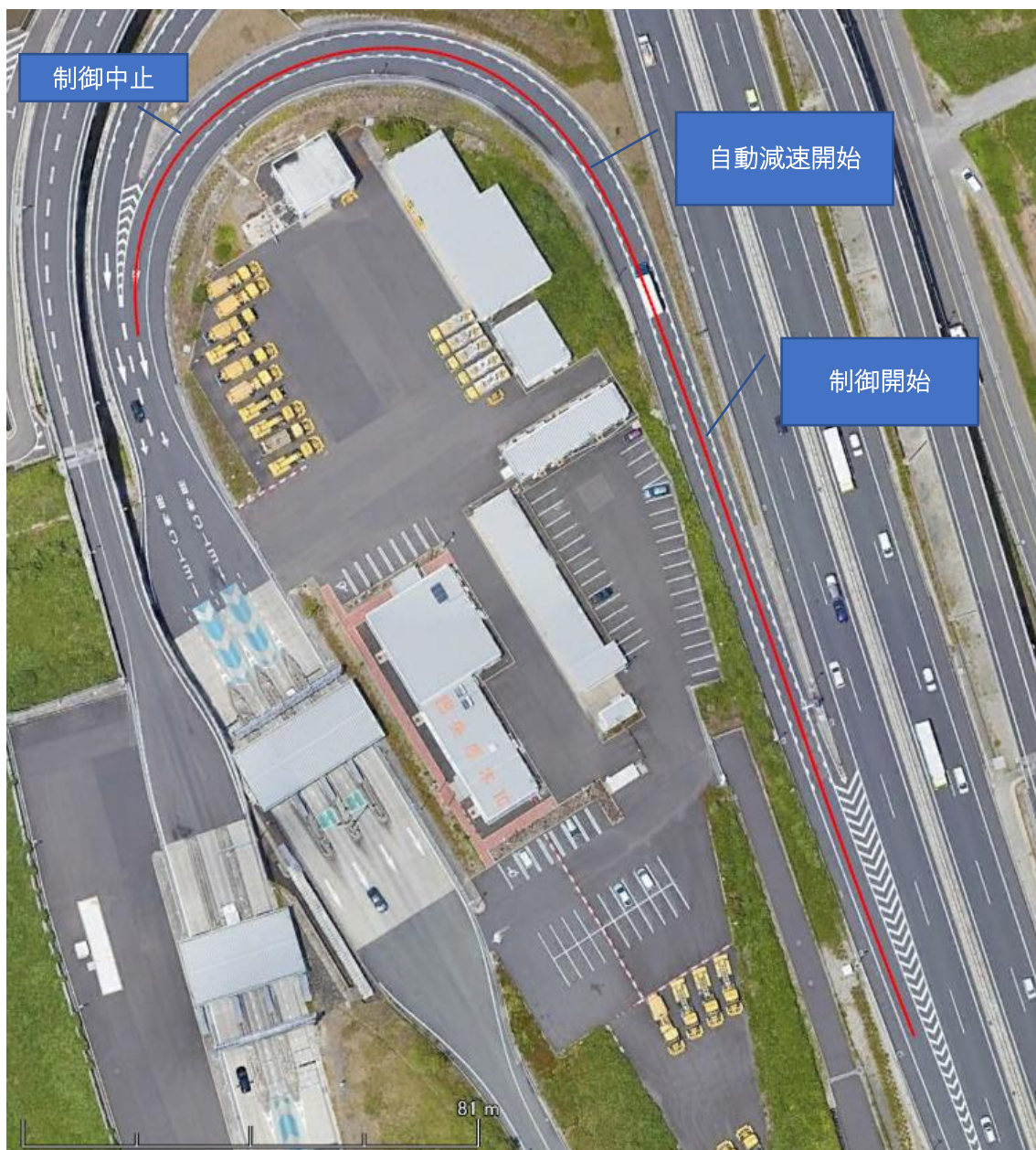
Fig. 7-36 低速コーナー（圏央厚木 IC）軌跡（米C車 Driver③）
