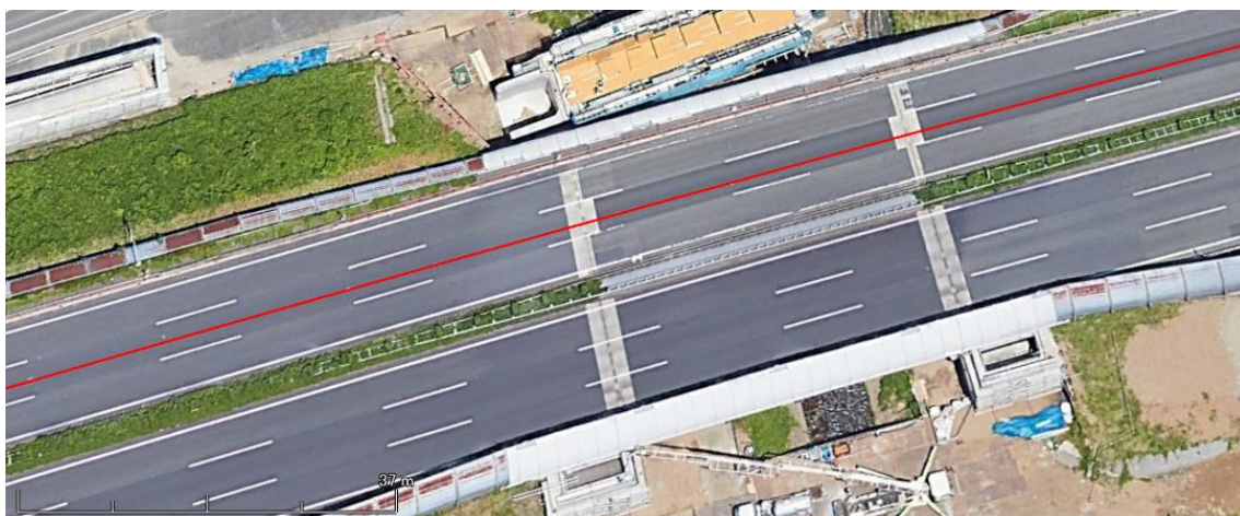
Fig. 5-24 高精度 IMU による走行軌跡プロット図
