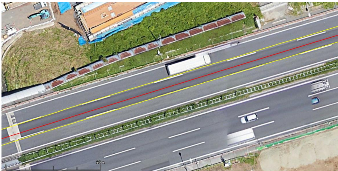
Fig. 5-26 高精度 IMU による走行軌跡と白線認識結果プロット図(補正後)
