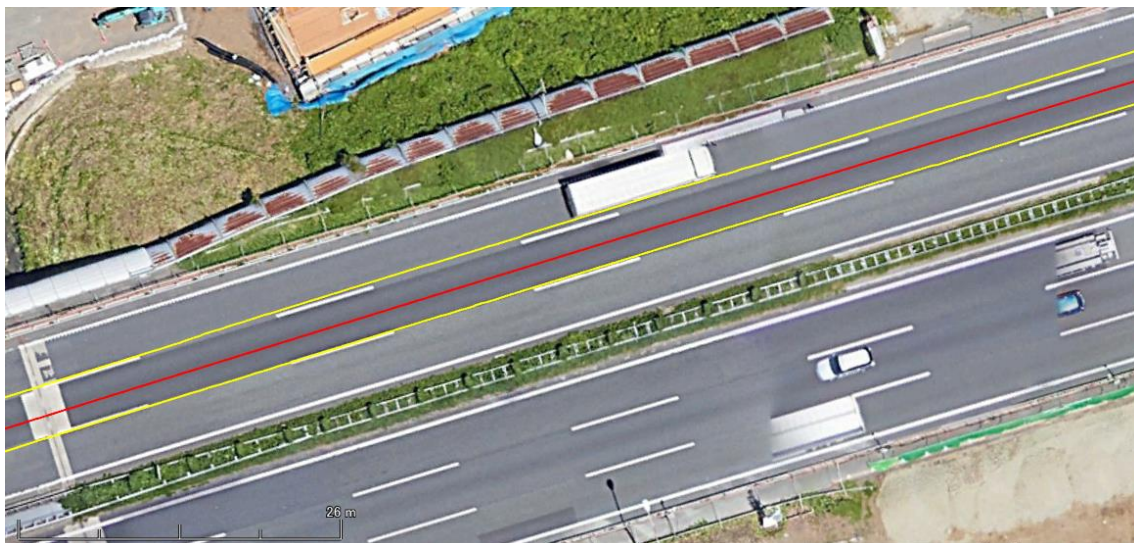
Fig. 5-25 高精度 IMU による走行軌跡と白線認識結果プロット図
