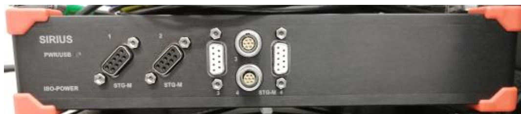
Fig. 5-3 SIRIUS 4ch ひずみ, 2ch カウンタユニット
