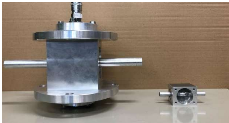
図3 外付け吸気抑止弁の新旧比較
