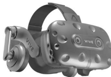
図 3. 研究で用いた HMD HTC Vive Pro Eye 視線計測機能付
