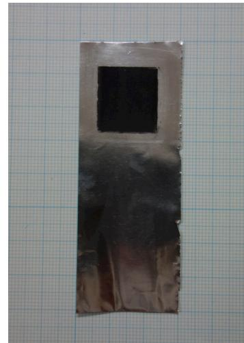
図2 作製した作用極の例
