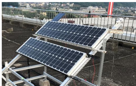
図3 実験に用いた PV ストリング
