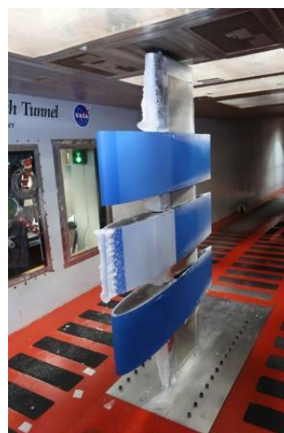
図 2. 着氷試験後の翼模型上の着氷
