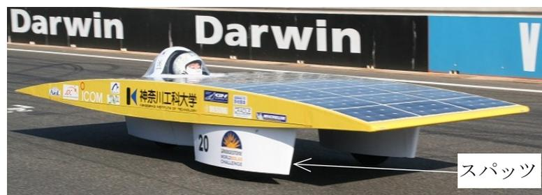
図1 神奈川工科大学ソーラーカープロジェクトチームが設計，製作し，Hidden Valley Motorsports Complex (Darwin, Australia) で走行するWSCに出場したソーラーカー 2013年10月撮影
