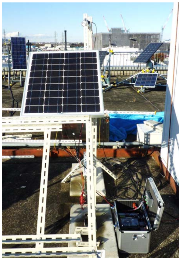
図1 小型太陽光発電システムおよび水素発生装置
