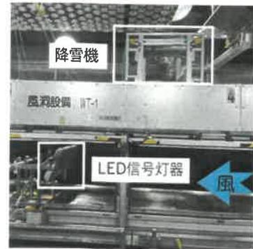
図.4.4 着雪風洞内の供試体
