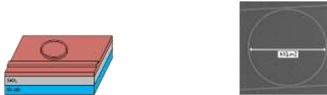
図 6. Nb<sub>2</sub>O<sub>5</sub> リング導波路共振器の概要図 図 7. 試作したリング導波路共振器の電子顕微鏡写真
