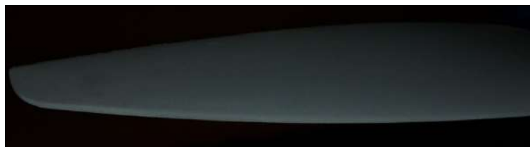
図 4.2.3.1 細粒砂環境での試験後のブレード
