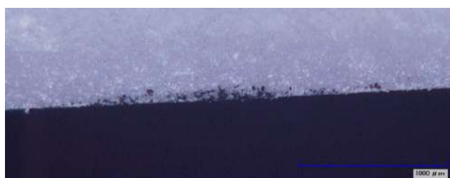
図 4.2.3.2 ブレード前縁部の浸食
