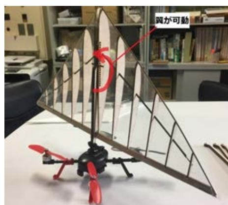
図8 製作したハイブリッド機
