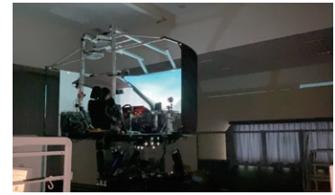
ドライビングシミュレータを用いた 車のデジタルツイン
