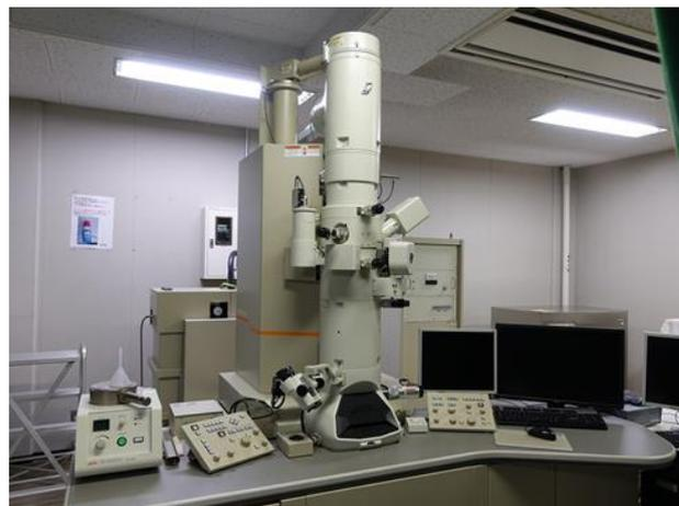
透過型電子顕微鏡装置
