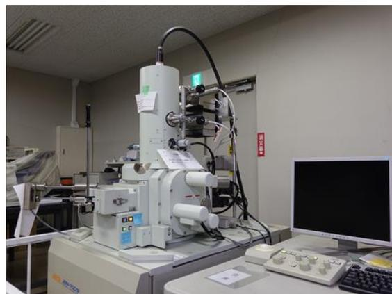
電界放出形走査型顕微鏡装置
