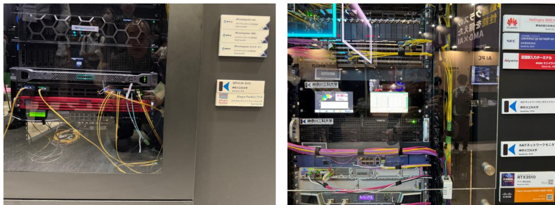
図 6 Shownet NOC ラック内の 400G Tap Aggregation Switch(左)とネットワークモニタ(右)
