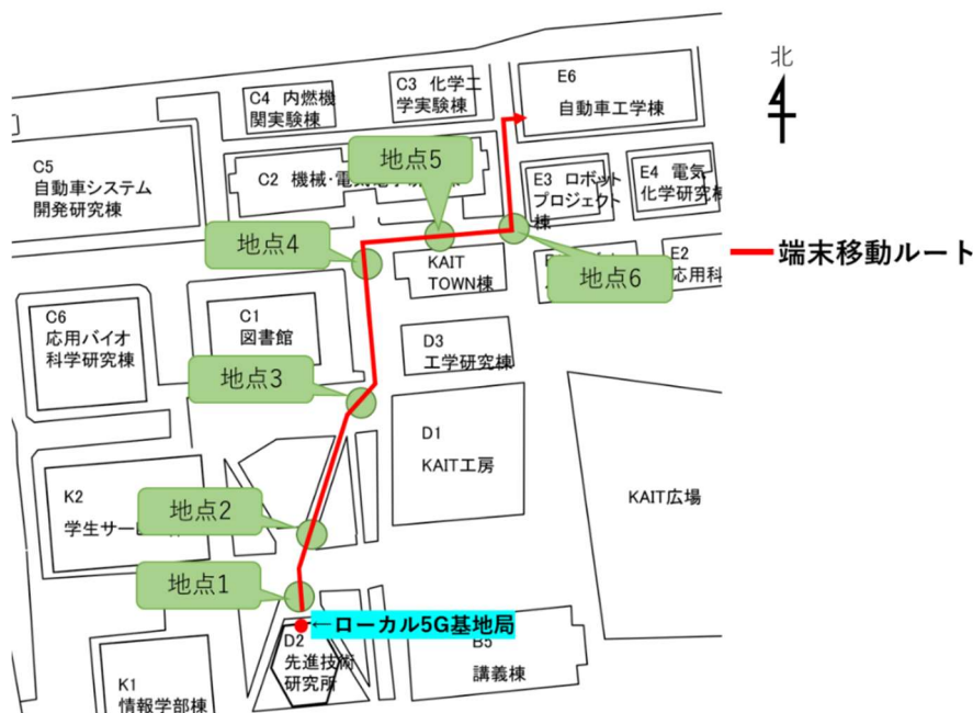
図 4.1.3 距離に応じたスループット計測実験
