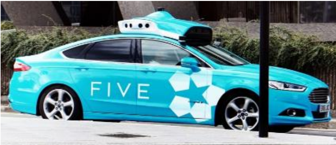
FiveAIの車両（搭載センサ：カメラ, LiDAR, Radar, GNSS等）
