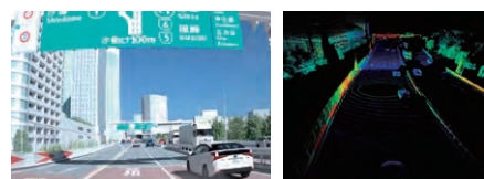
自動運転の仮想空間シミュレーションによるカメラとLiDAR映像
