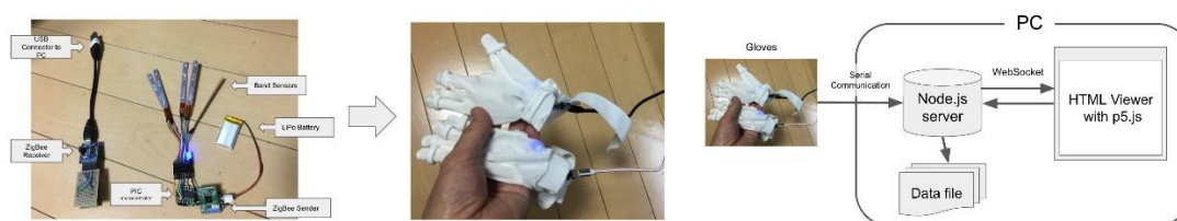
Fig. 2 幼児の手の動作取得グローブとデータ収集システム
