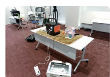
医療機器にポータブル電源から給電テスト
